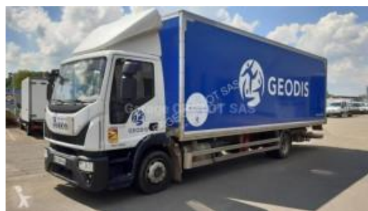
Фиг. 2. Товарен автомобил IVECO ML 120 E 22 P 4x2, използва дизелово гориво, Евро 6
