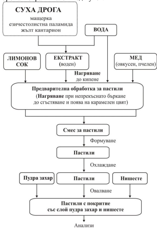
Схема 2. Технологична схема за влагане на водни екстракти и ароматизиран пчелен мед в билкови пастили
